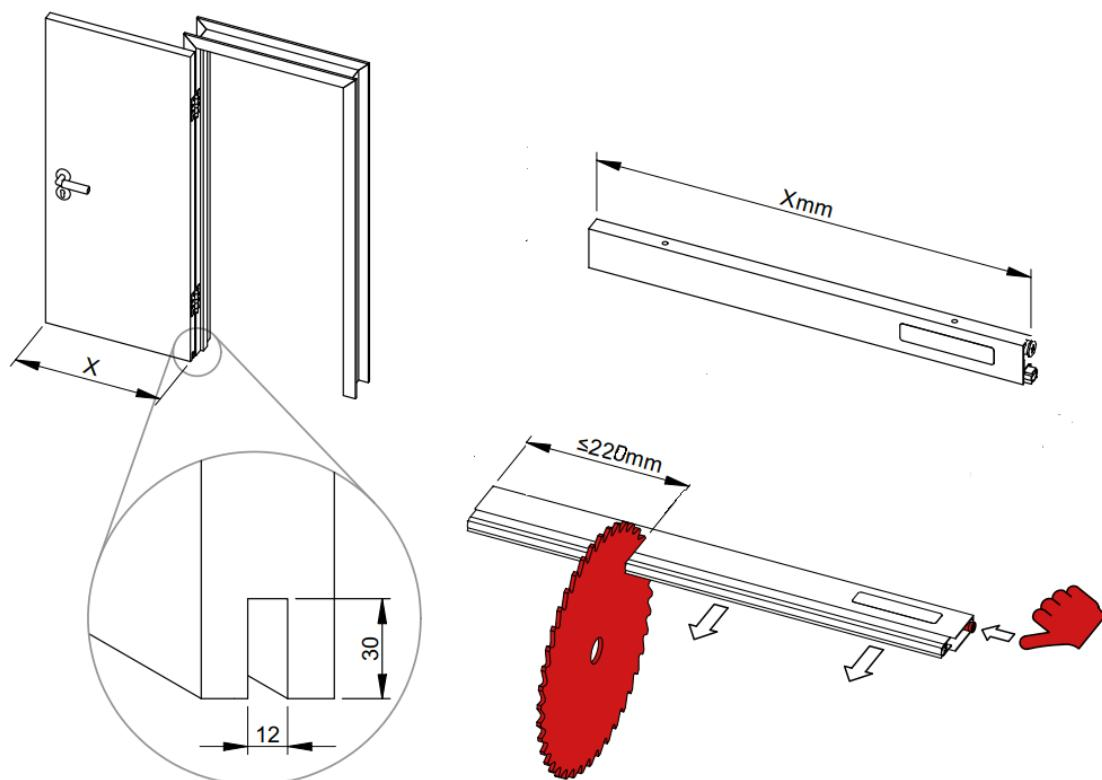
Извлечь уплотнитель из внутреннего зажимного профиля (внутренний зажимной профиль можно извлечь из направляющего профиля). Отпилить порог до нужной длины (отпилить не более 220 мм). Внутренний зажимной профиль должен быть короче направляющего профиля на 3мм. Зачистить напильником торцевую сторону отпила. Вставить уплотнитель в зажимной профиль. Отрезать уплотнитель до нужного размера, но оставить запас с каждой стороны (размер A, B).
